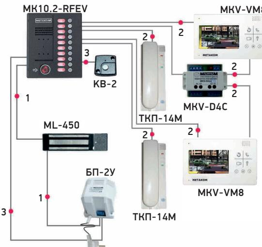
Схема подключения домофона MK10.2
