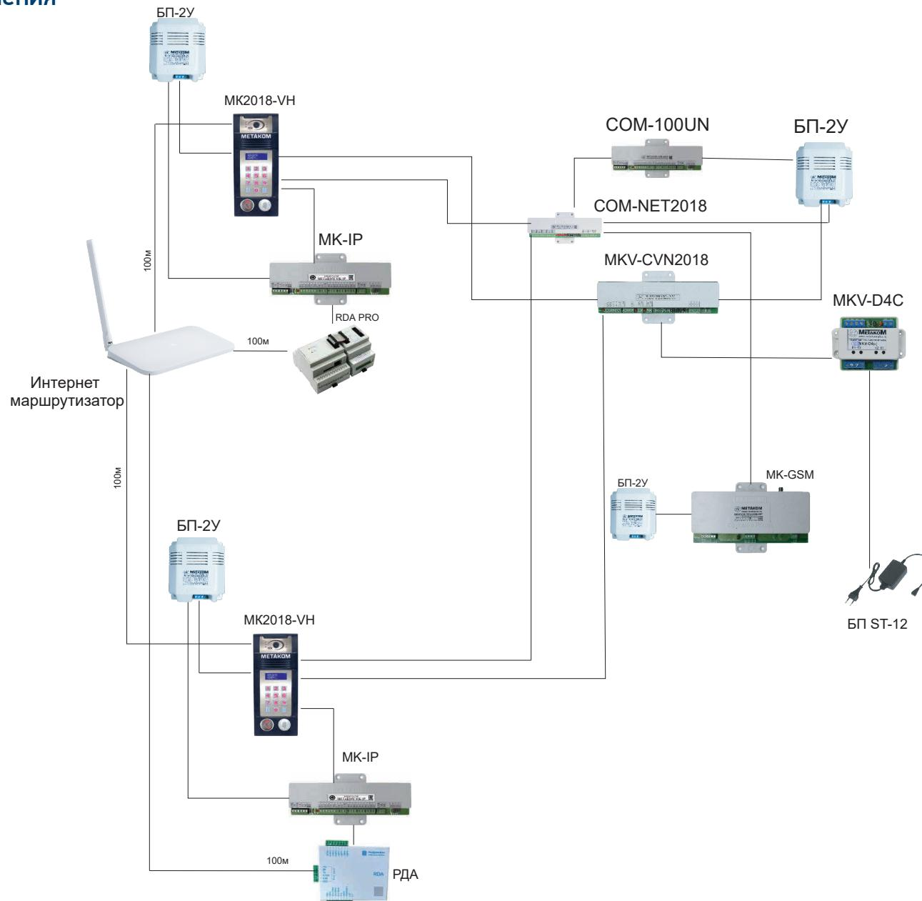
**Схема типовая подключения умного домофона. 1...4 калитки, вход в подъезд без домофона, до 31 подъезда. Видеодомофон.**
