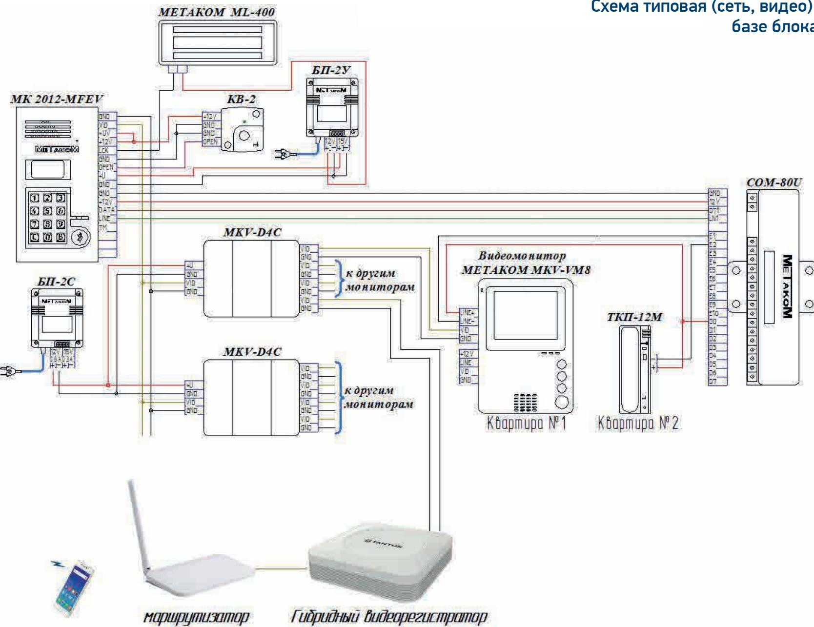
Схема типовая (сеть, видео) подключения
