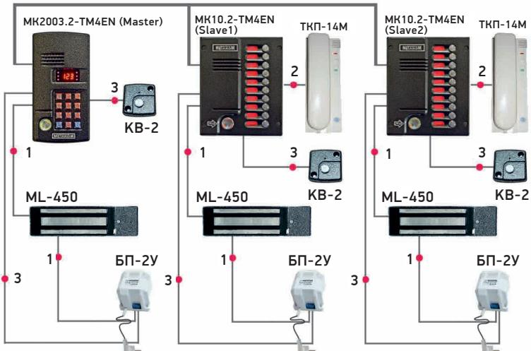
Схема подключения домофона MK10.2 в сеть
