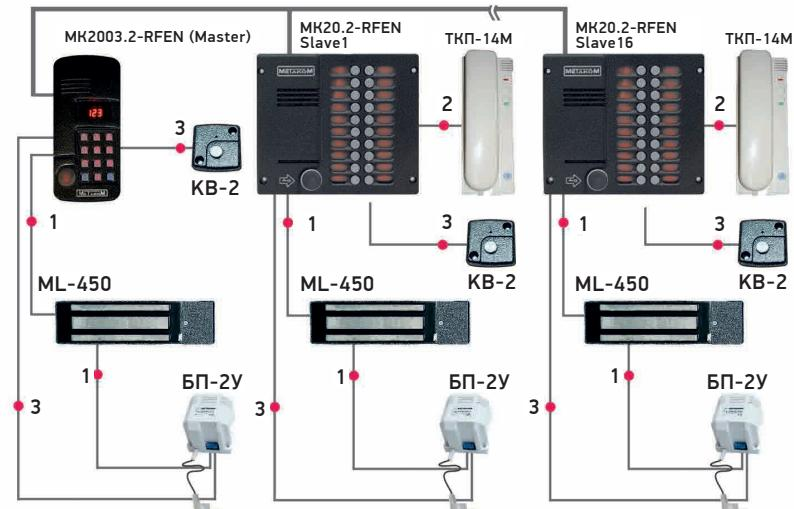
Схема подключения домофона MK 20.2 в сеть
