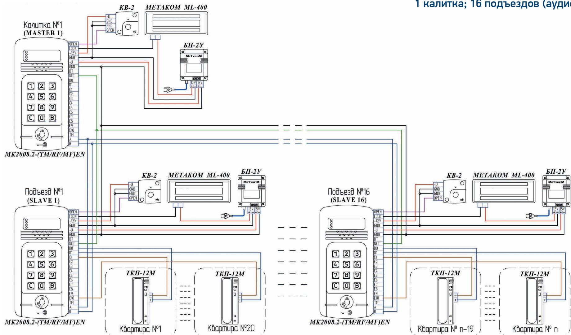
**МК 10.2 Схема типовая (сеть, аудио). Организация работы координатного многоабонентского блока вызова калитки совместно с подъездными блоками вызова с прямой системой адресации**
