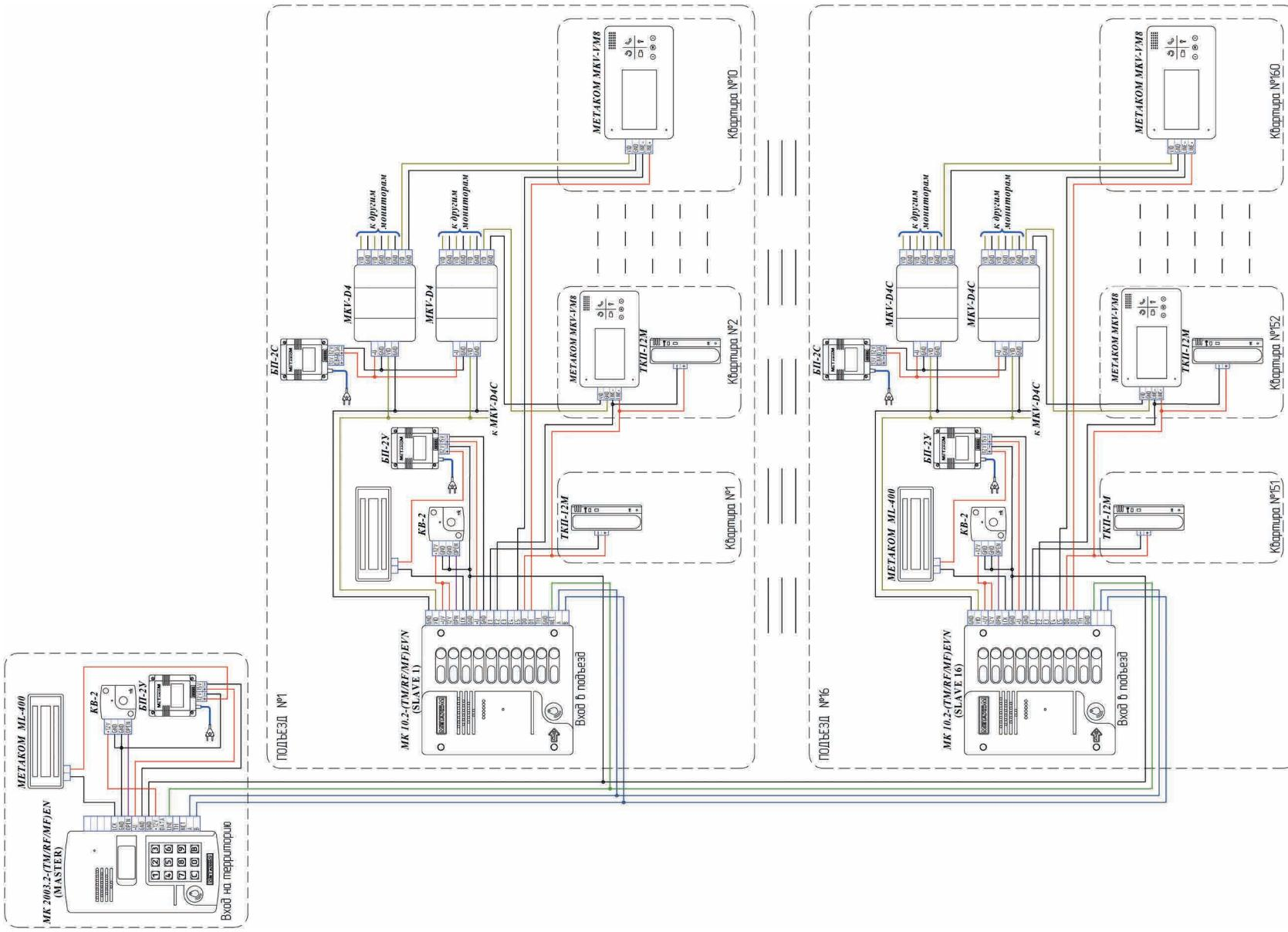
ТИПОВЫЕ РЕШЕНИЯ | ПОДКЛЮЧЕНИЕ ВИДЕОДОМОФОНОВ С ПРЯМОЙ СИСТЕМОЙ АДРЕСАЦИИ
