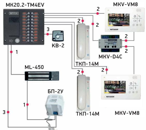
Схема подключения домофона MK 20.2
