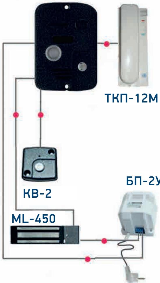
Схема подключения домофона
