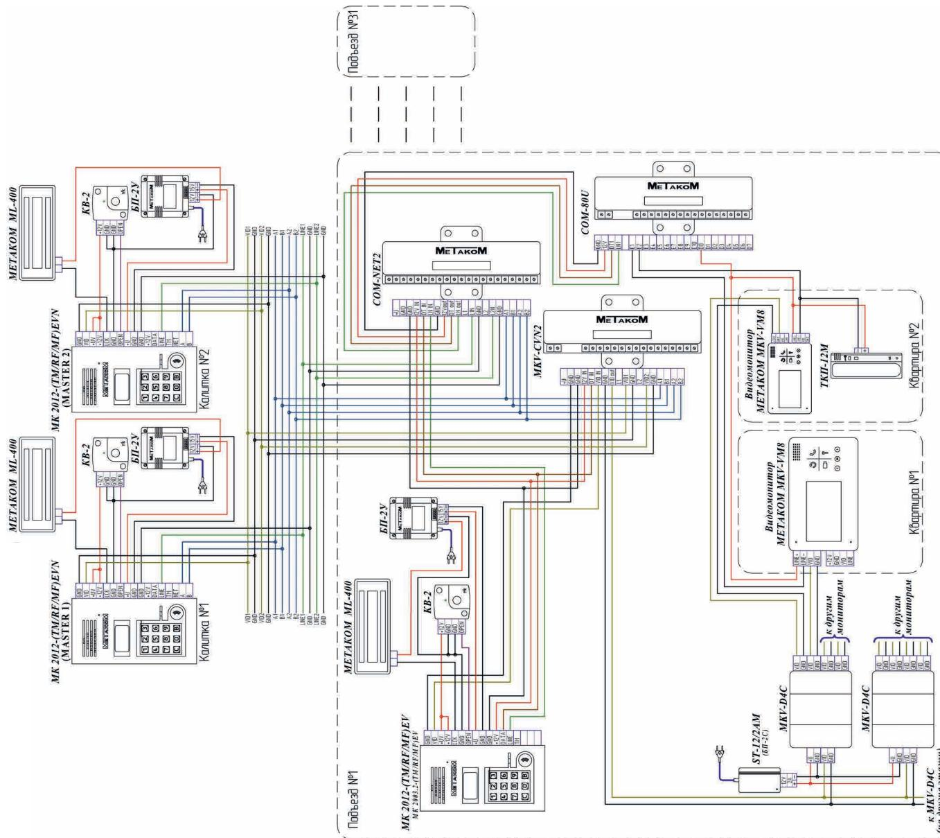
ТИПОВЫЕ РЕШЕНИЯ | ПОДКЛЮЧЕНИЕ МНОГОАБОНЕНТНЫХ ВИДЕОДОМОФОНОВ С КООРДИНАТНОЙ СИСТЕМОЙ АДРЕСАЦИИ В ЖИЛОМ ДОМЕ С ЗАКРЫТОЙ ТЕРРИТОРИЕЙ (2 КАЛИТКИ)
