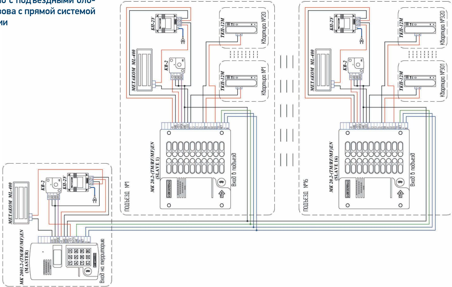
**МК 20.2 Схема типовая (сеть, видео). Организация работы координатного многоабонентского блока вызова калитки совместно с подъездными блоками вызова с прямой системой адресации**
