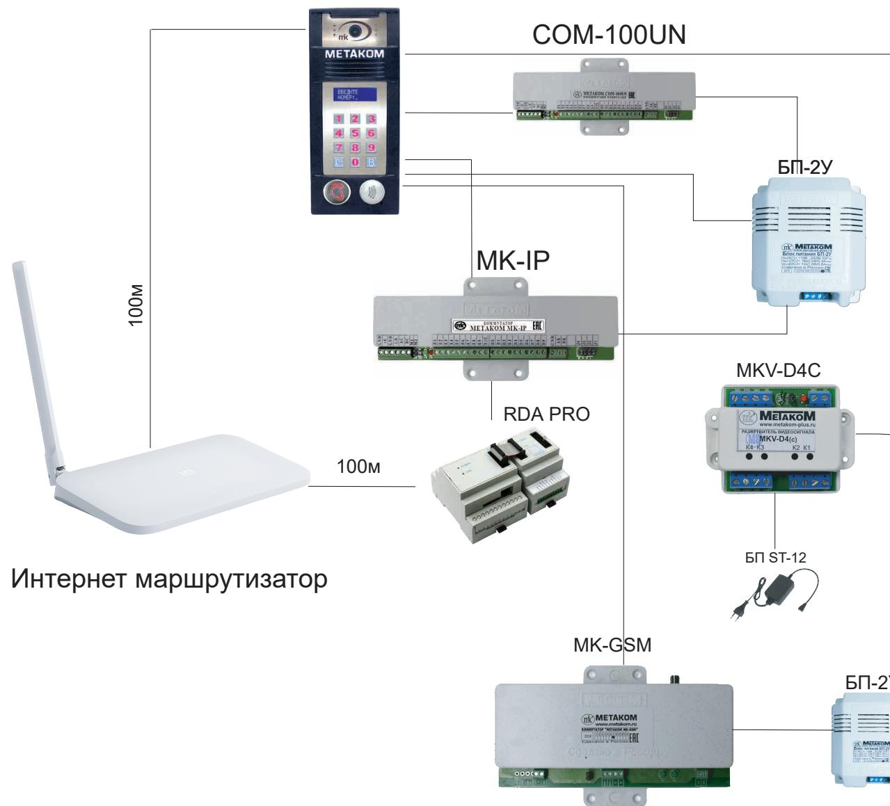
**Схема типовая подключения
